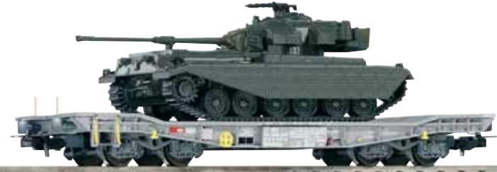
96681 Panzertransportwagen Slmmnps SBB Ep. IV - V, beladen mit Panzer 57 Nr. 132 mit Seitenschürzen 96681 Wagon CFF porte char type Slmmnps chargé d'un char PZ 57 no. 132 avec protection latérale
