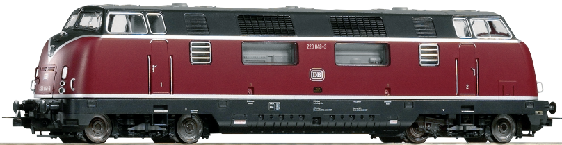
5714 Diesellok BR 220.0 DB Ep. IV, Drehgestelle mit Blattfederung
